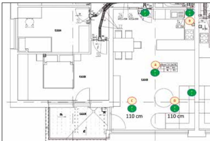
Prostor obývacího pokoje s místy měření intenzity větrání
