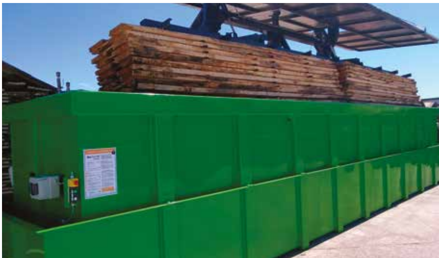
Máčení zajistí dlouhou dobu kontaktu pracovního roztoku se dřevem
