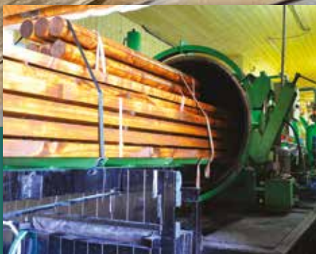
Impregnace dřeva proti biotickým škůdcům
