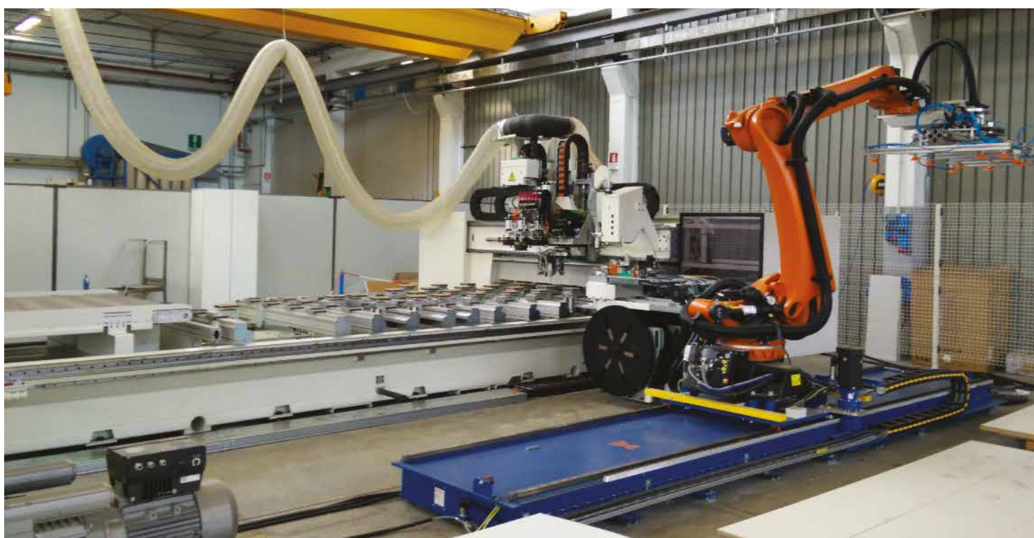
Pojíždný robot KUKA umístěný ze zadní strany CNC stroje Accord 40 FX (SCM)
