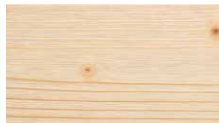
Kartáčování ve směru vláken odstraní měkké jarní dřevo z plochy. Tím je docíleno strukturovaného povrchu. Dřevo získá moderní, rustikální vzhled.
