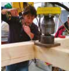
Zkouška únosnosti rybinové přípoje zesíleného vrutu WT (CVUT Praha)
