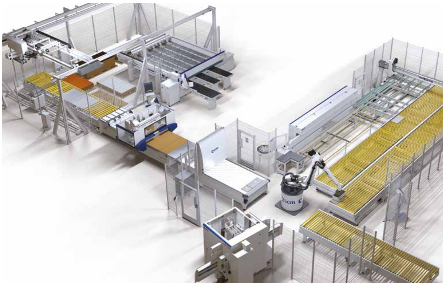
Výrobní buňka LeanCell 4.0 (SCM)
