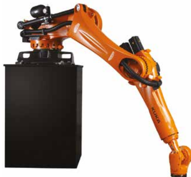
Robot pro zakládání a odebírání obrobků
