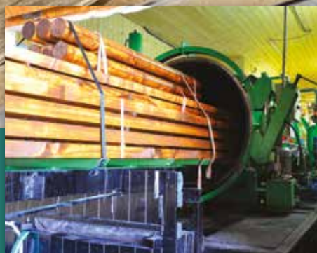
Impregnace dřeva proti biotickým škůdcům
