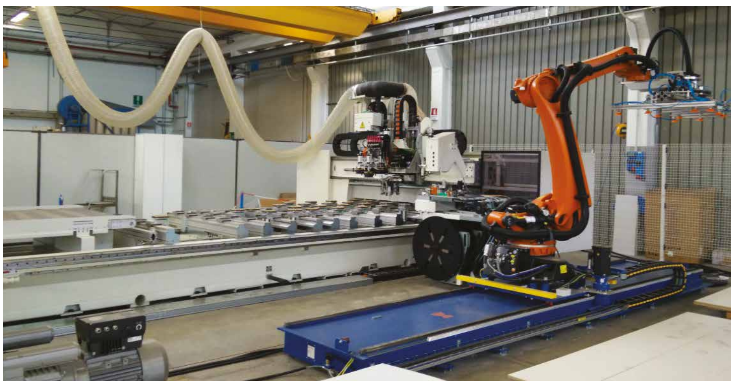
Pojízdný robot KUKA umístěný ze zadní strany CNC stroje Accord 40 FX (SCM)
