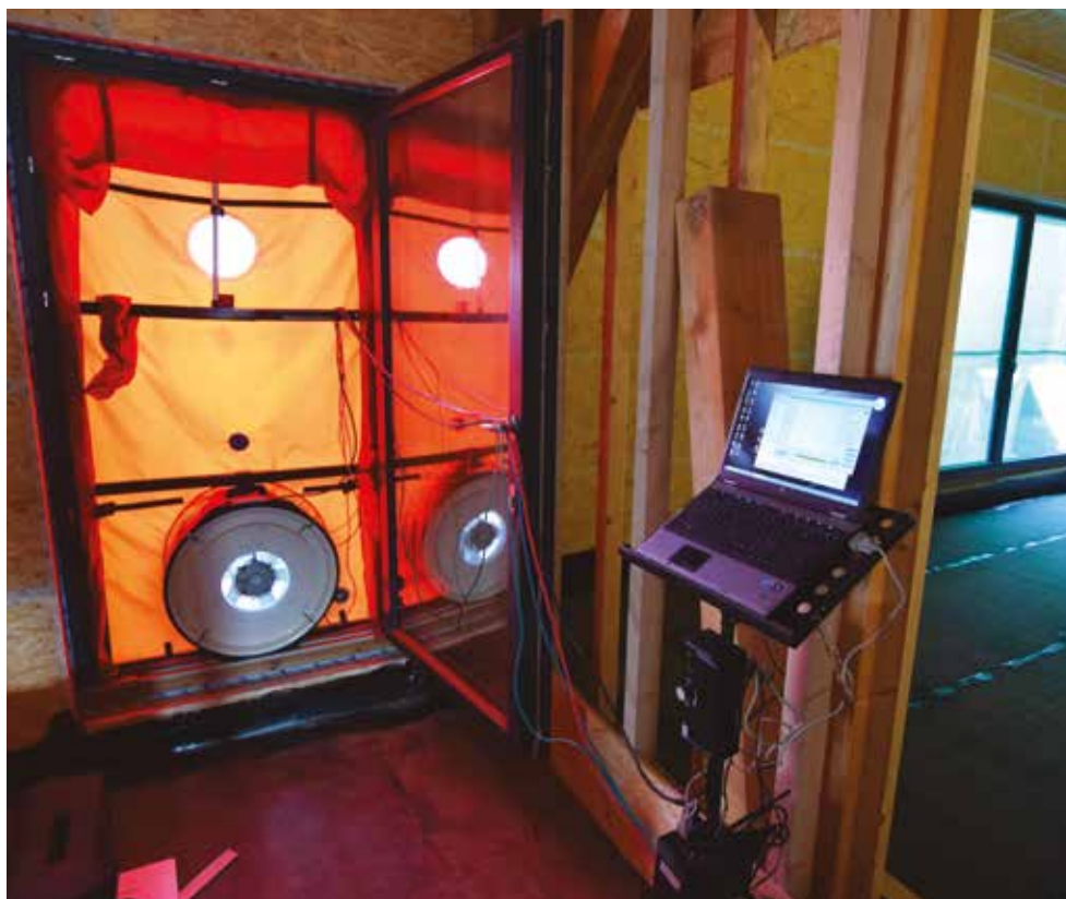
Zařízení Blower-door pro měření průvzdušnosti
