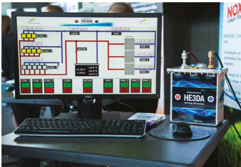
Baterie HE3DA je českým patentem – využívá anorganická nanovlákna v separátoru a celá její konstrukce je kromě elektrolytu nehořlavá
